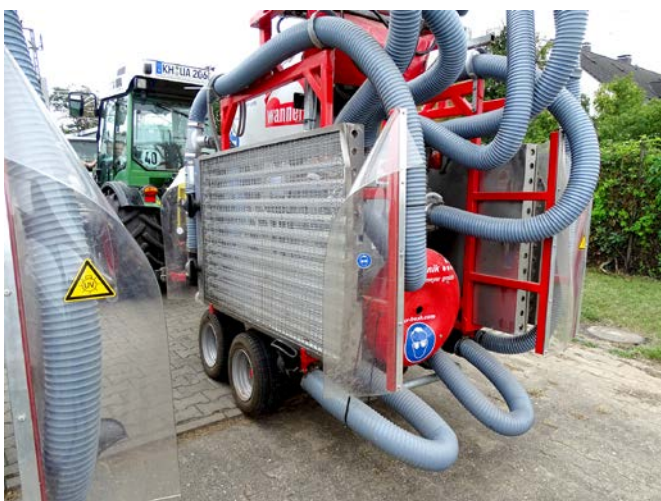
Abb. 5: Mobile Geräte-Technik zur Pilzbekämpfung im Weinbau durch UVC-Behandlung.
