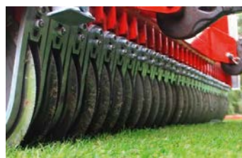
Overseeder mit gefederten Doppelscheiben. 140/180/240 cm.
