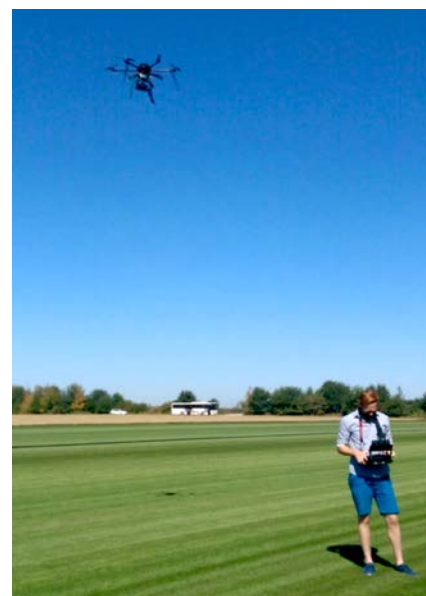
Abb. 3: Einsatz von Drohnen in der Fertigrasenproduktion beispielsweise zur Bestimmung der Flächengröße, zur Gesundheitsprophylaxe oder zur Erkennung von Dränleitungen. (Foto: Martin Bocksch)
