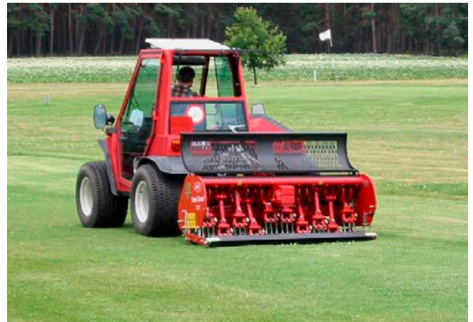
Abb. 2: Traktor mit Tiefenlockerungsgerät. (Foto: K.G. Müller-Beck)
