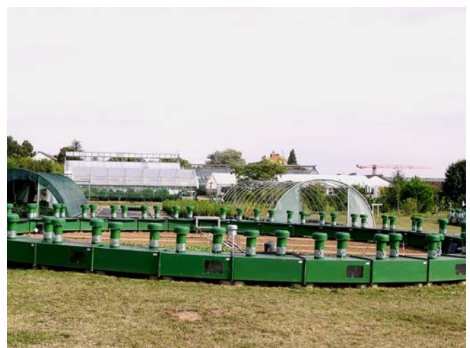
Abb. 6: FACE-Anlage an der Hochschule Geisenheim zur Erforschung der Auswirkungen erhöhter CO 2 -Konzentrationen auf die Entwicklung von Gemüsekulturen.
